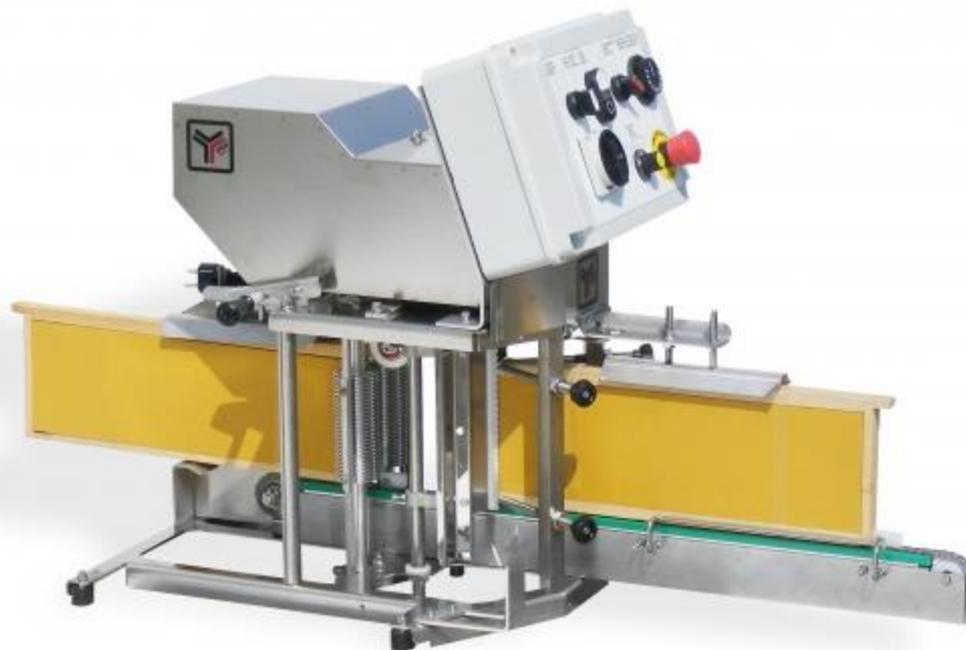
Disopercolatrice semiautomatica 'Daisy' (per favi da melario Dadant), con due coltelli dentellati riscaldati da resistenza elettrica con termostato ed oscillanti verticalmente per mezzo di un piccolo e silenzioso motoriduttore 220 V, catena inox per l'avanzamento dei favi e dispositivo 'apri-cella' sotto legno. Il supporto non è compreso.
